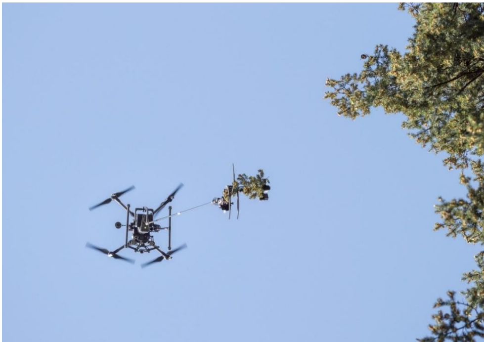
Abbildung 4: Sicherer Transport der Astprobe zum Piloten. (Foto: Andreas Müller, AWG)
