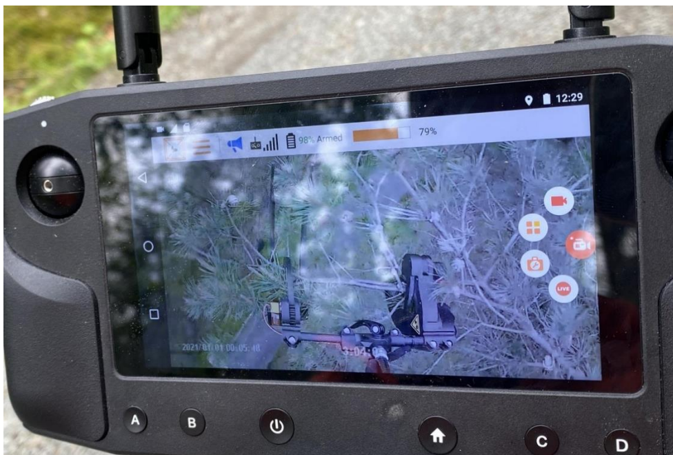
Abbildung 6: Perspektive der Greifarmkamera. Die Greif- und Schneidsequenz wird ausgelöst. (Foto: Simon Ecke, LWF)
