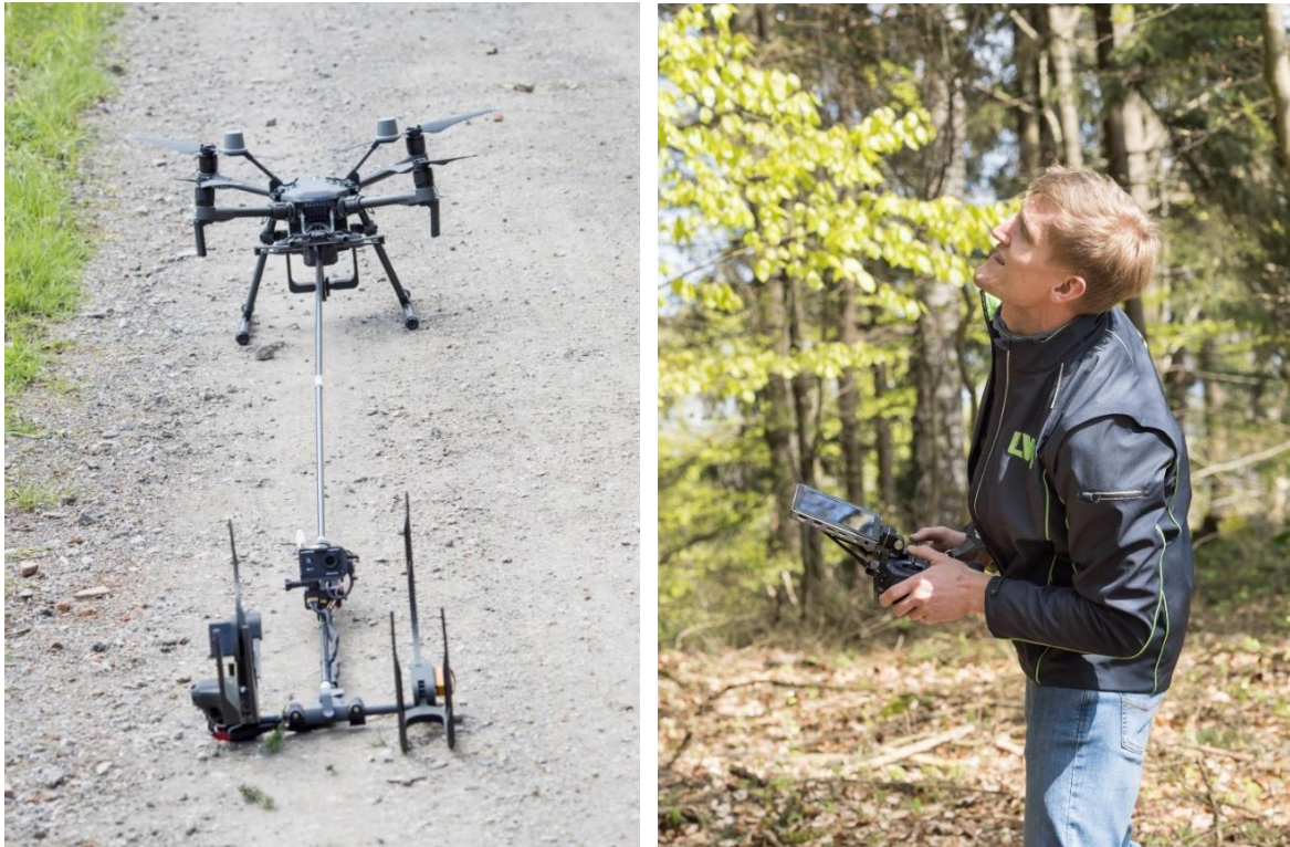
Abbildung 2: Quadkopter mit montiertem Greifarm inklusive Kamera und Drohnenpilot Simon Ecke (LWF). (Foto: Andreas Müller, AWG)
