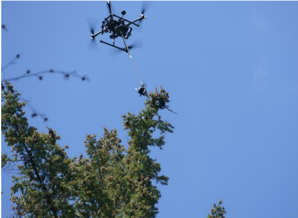
Abbildung 3: Anfliegen des gewünschten Probeastes und Auslösen der Greif- und Schneidsequenz. (Foto: Andreas Müller, AWG)
